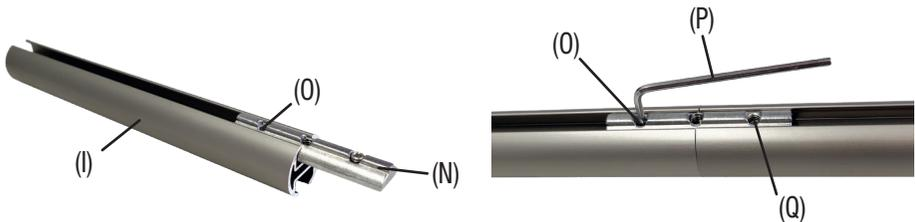
Möchten Sie einen Träger (siehe Schritt 4) genau bei der Profilstückerung setzen, kann der Nutstein (J) sowie die Schraube (F) vom Träger (D) abgenommen werden (Nutstein und Schraube werden nicht mehr benötigt). Befestigen Sie nun die Schraube (K), welche dem Profilverbinder beige packt ist, durch den Träger (D) am mittleren Loch des Profilverbinders (N).
