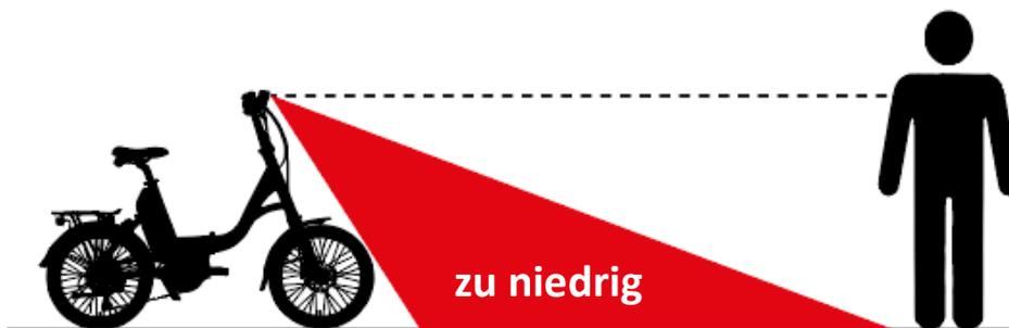
Stellen Sie Ihr Vorderlicht so ein, dass die Strecke vor Ihnen genügend ausgeleuchtet wird und, dass der entgegenkommende Verkehr nicht geblendet wird.
