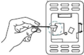
Der Sensor für die Luftqualitätsmessung sollte etwa alle 3-6 Wochen gereinigt werden. Nehmen Sie dazu vorsichtig die Abdeckung ab und reinigen Sie den Sensor mit einem mit reinem Wasser befeuchteten Wattestäbchen. Bitte keinen Alkohol oder sonstige Reinigungssubstanzen verwenden, da der Sensor sonst Schaden nimmt.
