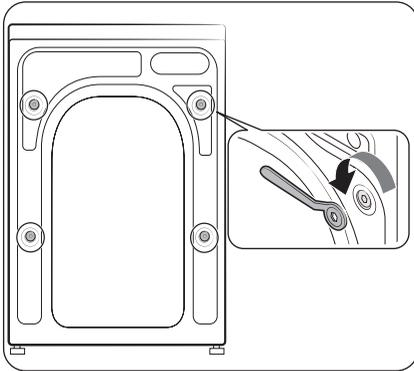
1. Suchen Sie die Transportsicherungen (in der Abbildung mit einem Kreis markiert) auf der Rückseite der Waschmaschine.
