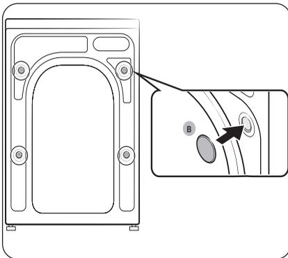
3. Setzen Sie die **Verschlusskappen (B)** in die Öffnungen ein (in der Abbildung mit einem Kreis markiert).
