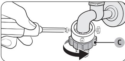
4. Schieben Sie den Adapter auf den Wasserhahn, ziehen Sie ihn hoch und ziehen Sie dann die Schrauben fest.
