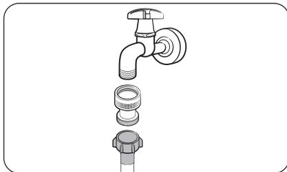
Bevor Sie den Wasserschlauch an einen Wasserhahn anschließen, müssen Sie das mitgelieferte Rückschlagventil an den Wasserhahn anschließen und dürften erst dann den Wasserschlauch anschließen.
