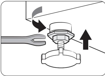
3. Wenn Sie das Gerät ausgerichtet haben, ziehen Sie mit dem Schraubenschlüssel die Muttern fest.
