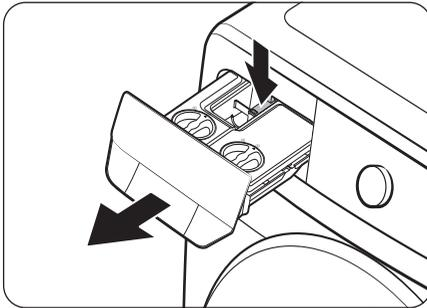
1. Drücken Sie den **Entriegelungshebel** im Innern des Behälters herunter und ziehen Sie zugleich die Waschmittelschublade heraus.
