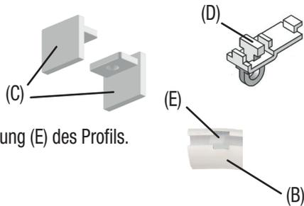
Drehen Sie den Feststeller (D) in die Ausstanzung (E) des Profils.
