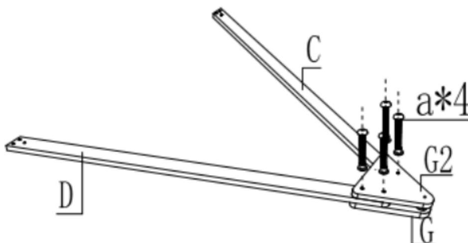
Verbinden Sie C und D durch G und G2 und befestigen Sie sie mit 4 Stück M5\*60. Legen Sie es dann für eine spätere Verwendung beiseite. Nach der Installation für die spätere Verwendung beiseitelegen.
