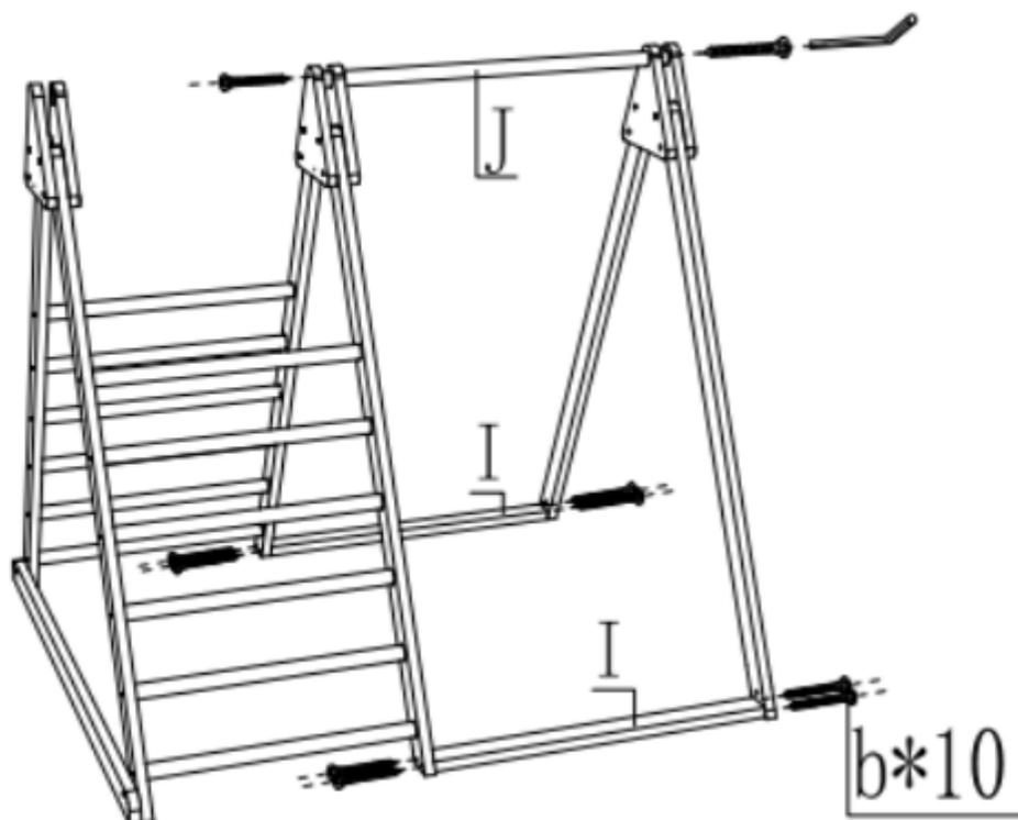
Verbinden Sie die in den Schritten 3 und 4 installierten Teile mit 10 Stück M6\*30.
