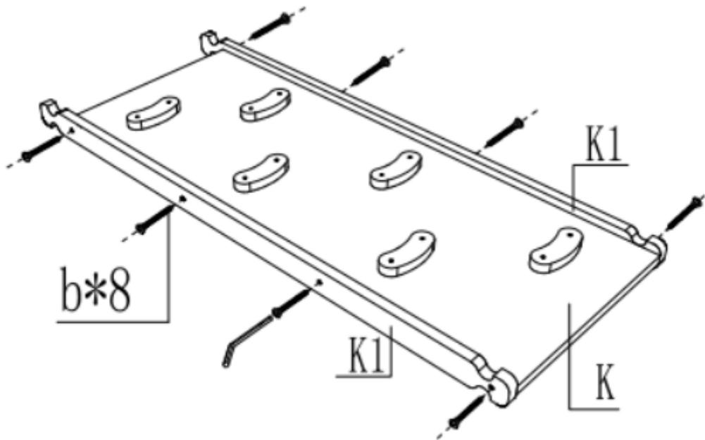
Verbinden Sie zwei Schieberseitenteile K1 mit Schieber K mit 8 Stück M6\*30.
