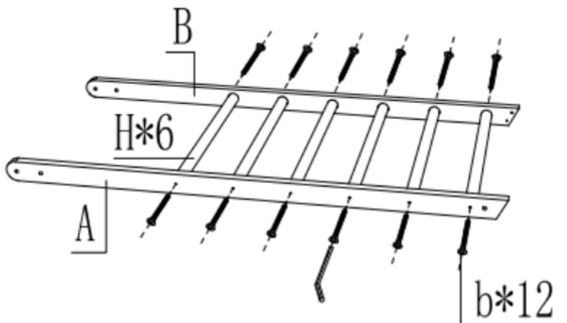
Verbinden Sie A und B mit 6 Stück H und verbinden Sie sie mit 12 Stück M6\*30.
