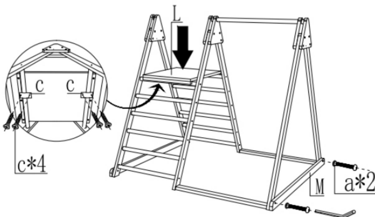
Installieren Sie das L-Brett an der Kletterleiter und fügen Sie die M-Tretlagerhalterung wie in der Abbildung gezeigt an der Unterseite des Stativs hinzu und verbinden Sie sie mit zwei M5 \* 60-Stücken. Und verwenden Sie 4 Stück M7\*50, um das Rückspulband des C-Teils zu befestigen.
