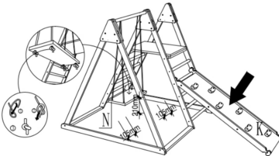
Installieren Sie die Schaukel in der entsprechenden Position, und legen Sie den Schieber auf den ersten oder zweiten runden Stab des Hauptkörpers, und der gesamte Installationsvorgang ist abgeschlossen (bitte platzieren Sie ihn nicht auf dem dritten oder oberen runden Stab, da dies sonst aufgrund des übermäßigen Neigungswinkels zu Gefahren führt).
