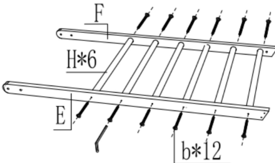
Verbinden Sie E und F mit 6 Stück H und verbinden Sie sie mit 12 Stück M6\*30.
