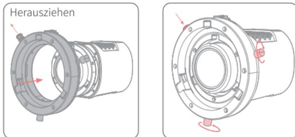
Installieren Sie zuerst den Bowens Adapterring in der richtigen Position. Die Laschen werden so aussehen, als würden sie die Halterung der Bowens Halterung blockieren. Heben Sie die Laschen auf beiden Seiten an, damit der Ring passt. Sobald die Laschen vollständig in die Positionierungslöcher der Bowens Halterung eingeführt sind, ziehen Sie die obere Stiftschraube an der Unterseite fest, um den Adapterring vollständig zu sichern.
