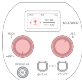
① Drücken Sie kurz die "MODE"-Knopf, um in den FX-Modus zu wechseln.
