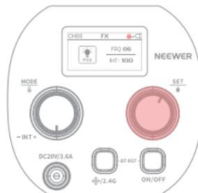
Drücken Sie in einem beliebigen Modus lange auf die Taste "
