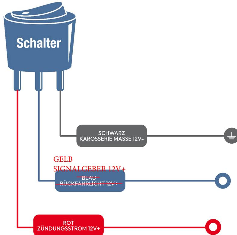
Bei dieser Variante wird die gesamte Anlage über den mitgelieferten Schalter aktiviert. Dadurch können Sie den Betrieb der Einparkhilfe flexibel nach Ihren Bedürfnissen ein und ausschalten.
