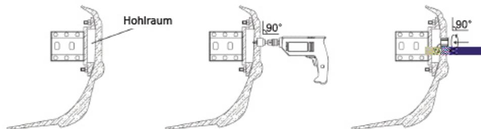
Gehen Sie bitte sicher, dass sich hinter der geplanten Bohrstelle ein Hohlraum befindet. Es dürfen keine Karosserieteile, Kabel oder ähnliches dort verlaufen. Der Bohrwinkel zur Stoßstange muss exakt im 90° Winkel erfolgen. Geringe Neigungen in der Stoßstange, können mit den beiliegenden Ausgleichsrings korrigiert werden. Setzen Sie dazu einen Ausgleichsring zwischen Stoßstange und dem Sensor um einen möglichst idealen Einbauwinkel vom 90° zu erreichen.
