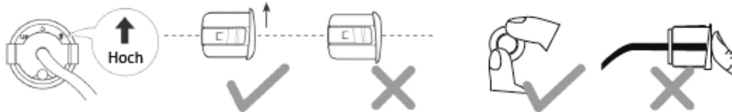
Die Sensoren sind mit einem Pfeil auf der Rückseite oder den Buchstaben „UP“ gekennzeichnet. Dieser markiert die Oberseite des Sensors. Dieser Teil muss also beim Einbau nach Oben zeigen. Beim Einsetzen drücken Sie bitte nur auf die Außenränder des Sensors. Drücken Sie keinesfalls in den Mittelteil. Dort liegen empfindliche Messteile. Diese können bei Druck zerstört werden.
