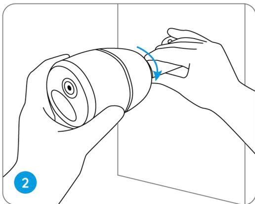
3. Um das beste Sichtfeld zu erhalten, lockern Sie den Einstellknopf an der Sicherheitshalterung und drehen Sie die Kamera.
