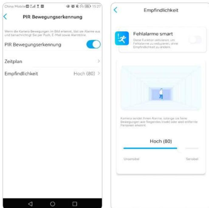
Ziehen Sie den Balken, um die Empfindlichkeit von niedrig, mittel bis hoch einzustellen oder stellen Sie die Empfindlichkeit von 1 bis 100 ein. Für Kameras mit digitalen PIR-Sensoren gibt es außerdem eine Option zur Reduzierung von Fehlalarmen.
