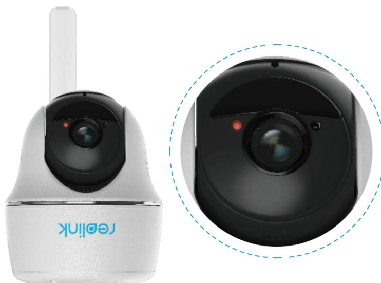
3. Eine blaue LED blinkt ein paar Sekunden lang und leuchtet dann dauerhaft, bevor sie erlischt. Sie hören die Sprachansage "Netzwerkverbindung erfolgreich", was bedeutet, dass die Kamera erfolgreich mit dem Netzwerk verbunden wurde.
