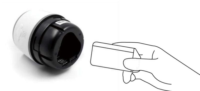
2. Suchen Sie den Steckplatz für die Micro-SD-Karte und drücken Sie die SD -Karte mit einem spitzen Gegenstand wie dem Reset-Pin, einer Büroklammer oder Ihrem Fingernagel heraus, damit sie herausspringt.
