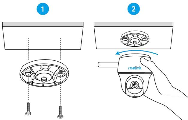
Bringen Sie die Halterung an der Decke an und befestigen Sie die Kamera daran.
