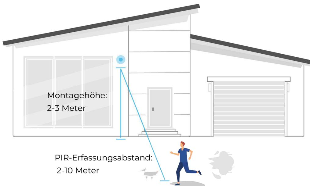
3. Passen Sie die Installationshöhe an. Es wird empfohlen, eine Kamera 2 bis 3 Meter über dem Boden zu montieren. Wenn Sie die Kamera zu niedrig oder zu hoch anbringen, ist es schwierig, einen Alarm zu erkennen.
