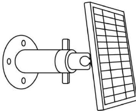
Schritt 4. Lösen Sie den Einstellregler an der Halterung und stellen Sie den Winkel des Solarmoduls so ein, dass es direkte Sonneneinstrahlung erhält. Ziehen Sie dann den Einstellregler fest, um das Solarmodul zu fixieren .
