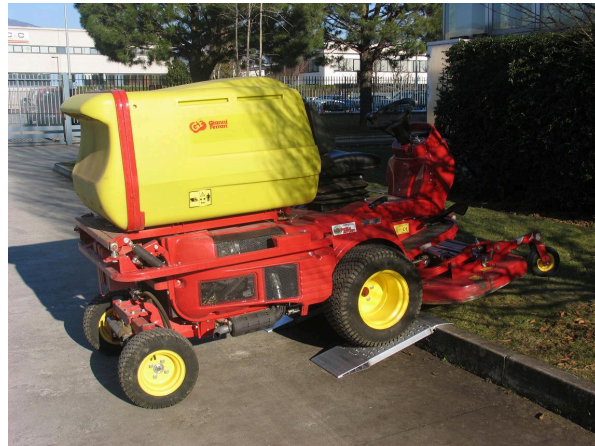
Container Verladerampen (500mm lang x 215mm breit x 1250kg Tragkraft)
