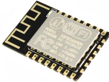
Das ESP12-F ist ein Ultra-Low-Power UART-WiFi-Modul speziell konzipiert für die Bedürfnisse der vernetzten Welt. Es bietet einen hervorragenden Funktionsumfang in kleinster Bauform. Speziell entwickelt für mobile Geräte und das Internet of Things bietet das ESP12-F eine eigenständige Netzwerklösung.
