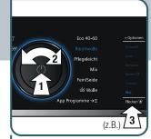
Gerät einschalten. Programmwähler auf das gewünschte Programm drehen. Programm gegebenenfalls wie folgt anpassen:
