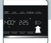
Programm durch Drücken der Taste «M >» starten. Nach der Beladungserkennung wird Wasser eingelassen und der Waschvorgang startet.
