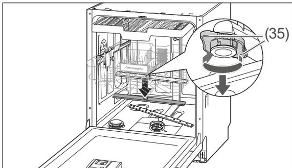
3. Der obere Sprüharm ist mit einem Bajonett-Verschluss befestigt. Zum Abnehmen des Sprüharms halten Sie die beiden gezackten Bajonettgriffe (35) fest, und drehen Sie den Sprüharm im Uhrzeigersinn ab.
