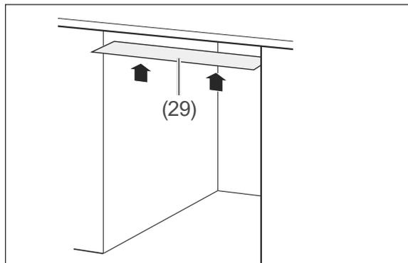
3. Kleben Sie die beiliegende Schutzfolie für Kondenswasser (29) auf die Unterseite der Arbeitsplatte. So vermeiden Sie Schäden an der Arbeitsplatte aufgrund heißer Dämpfe, die bei geöffneter Gerätetür aus dem Innenraum strömen.
