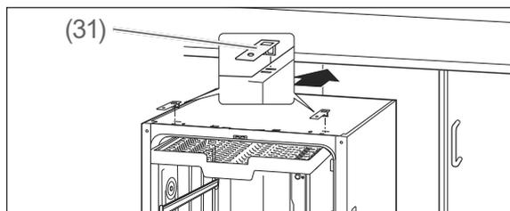
4. Stecken Sie beide Montagewinkel (31) in die vorderen Schlitz an der oberen Seite des Geräts, um später das Gerät an die Arbeitsplatte anschrauben zu können.
