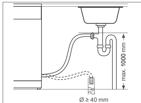
Sie können den Auslass des Ablaufschlauchs (15) auf zwei verschiedene Arten anschließen lassen:
