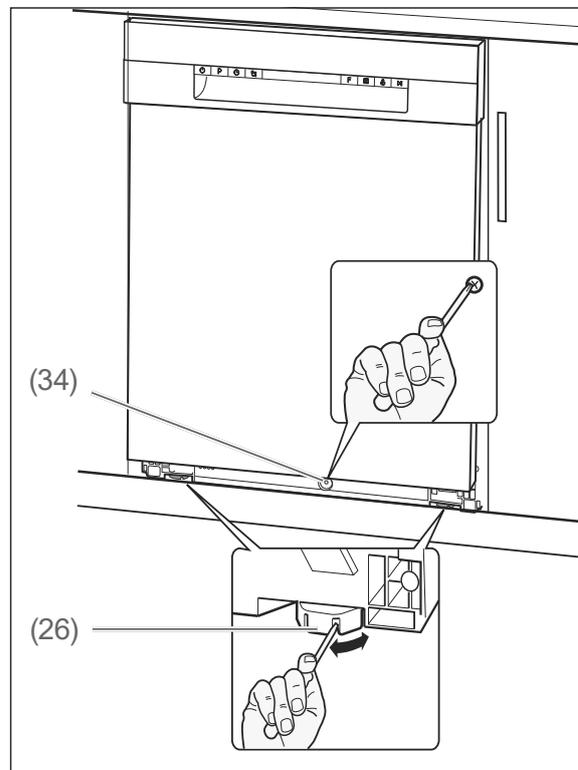
1. Stecken Sie einen Kreuzschlitz-Schraubendreher in einen der Schlitz und drehen Sie die Stellfüße (26) damit in die gewünschte Höhe.
