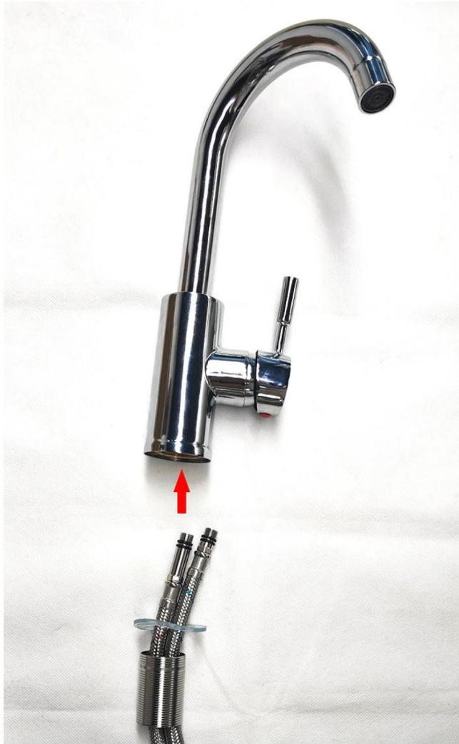
1. führen Sie die Kalt- und Warmwasserzulaufrohre nacheinander durch den kreisförmigen Spiralling und den wasserdichten Dichtungsring, und drehen Sie dann die beiden Wasserzulaufrohre in den Wasserhahn
