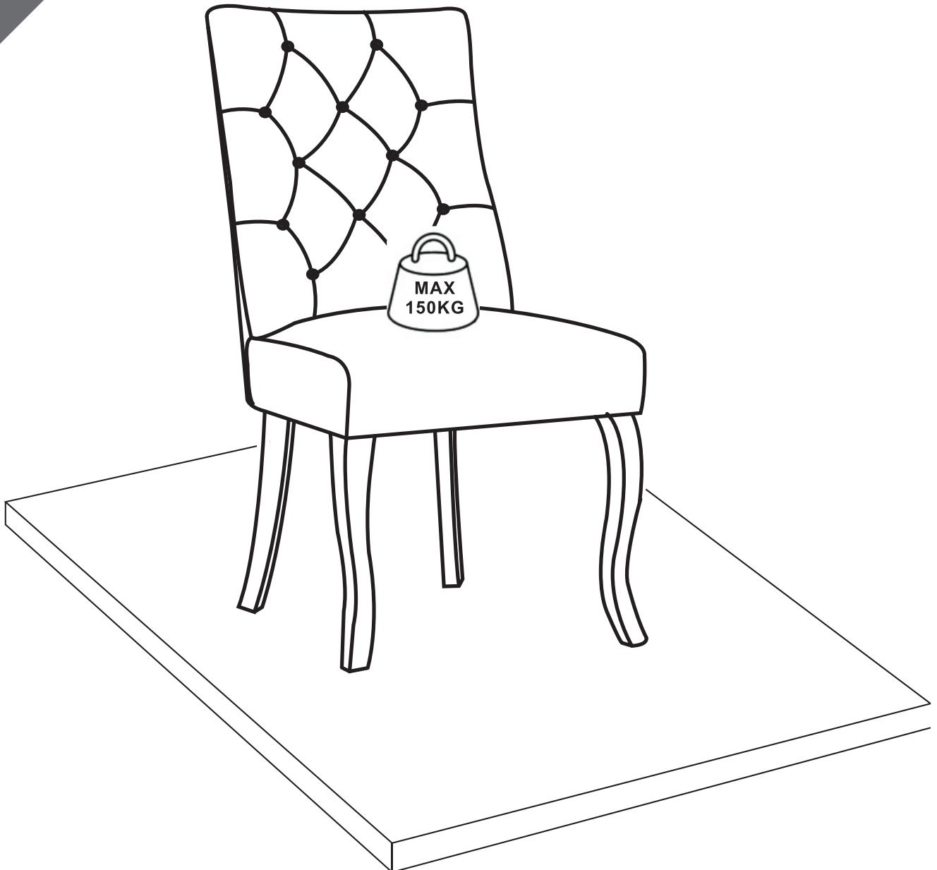
Vor dem Einbau die Schrauben in die Löcher stecken und festziehen, aber nicht bis 100%, 70% bis 80% anziehen reicht aus. Wenn alle vier Beine des Stuhls den Boden berühren können, ohne zu schütteln, ziehen Sie alle Schrauben auf 100%. Wenn Sie auf diese Probleme stoßen, z.B. wenn die Löcher nicht ausgerichtet werden können oder einige Teile nicht installiert werden können, überprüfen Sie bitte, ob die Schrauben korrekt verwendet werden und passen Sie die Dichtheit der Schrauben an.
