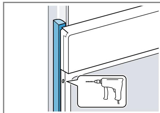
4. Das Gerät mit adäquater Schraube befestigen.
