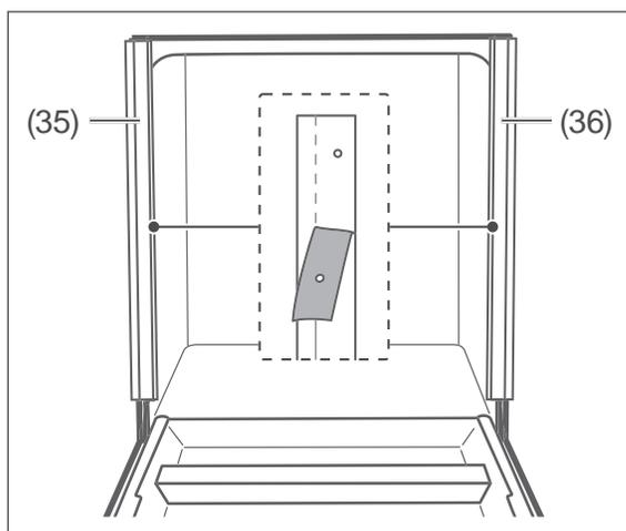
6. Entfernen Sie die Schutzfolien von der linken Dämmleiste (35) und der rechten Dämmleiste (36).
