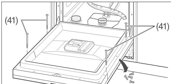
7. Entfernen Sie die 4 Schrauben an der Innenseite der Tür. Schrauben Sie die Möbelfrontplatte an diesen Positionen mithilfe der beiliegenden 4 Schrauben (41) fest. Die Möbelfrontplatte ist fertig montiert.
