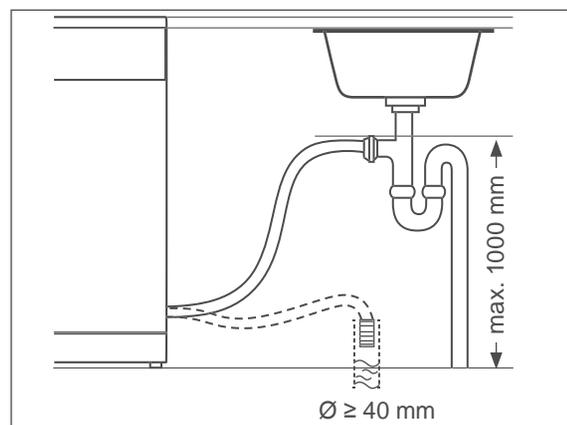
Sie können den Auslass des Ablaufschlauchs (19) auf zwei verschiedene Arten anschließen lassen:
