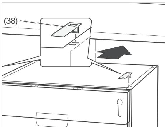
4. Stecken Sie beide Montagewinkel (38) in die vorderen Schlitze an der oberen Seite des Geräts, um später das Gerät an die Arbeitsplatte anschrauben zu können.
