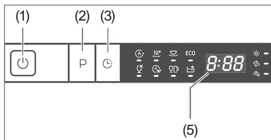
3. Drücken Sie innerhalb von 60 Sekunden nach dem Einschalten 5 Sekunden lang die Taste
