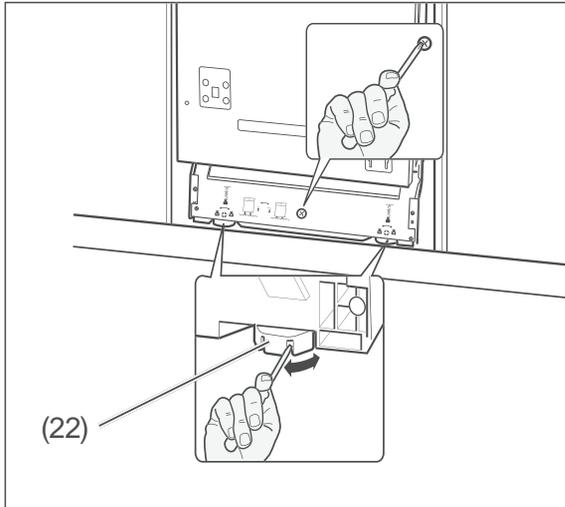
1. Stecken Sie einen Kreuzschlitz-Schraubendreher in einen der Schlitze und drehen Sie die Stellfüße damit in die gewünschte Höhe.
