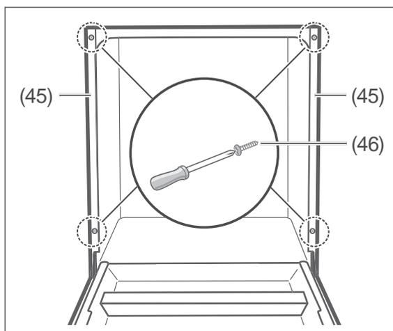
5. Entfernen Sie die vier Seitenleistenschrauben (46) aus den Seitenleisten (45).
