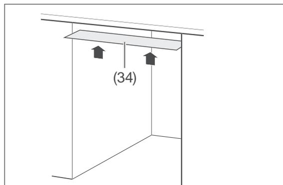
3. Kleben Sie die beiliegende Schutzfolie für Kondenswasser (34) auf die Unterseite der Arbeitsplatte. So vermeiden Sie Schäden an der Arbeitsplatte aufgrund heißer Dämpfe, die bei geöffneter Tür aus dem Innenraum strömen.
