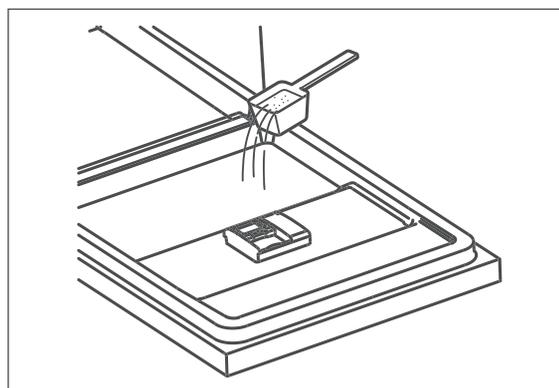
3. Geben Sie die restlichen 1/5 des Geschirrspülmittels auf die Innenseite der Gerätetür. Diese Menge verwendet das Gerät während des Vorspülprogramms.
