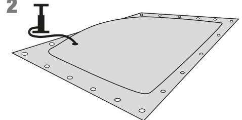
Mit maximal 20% Luft befüllen\* und anschließend auf dem Pool positionieren.
