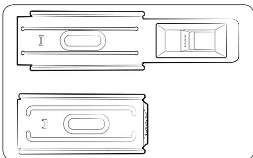
1. **I Vorwaschmittelfach:** In dieses Fach wird bei Bedarf Vorwaschmittel gefüllt.
