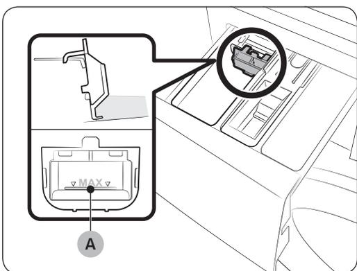
Setzen Sie zunächst den Flüssigwaschmitteleinsatz in das **II Hauptwaschmittelfach** ein. Füllen Sie anschließend Flüssigwaschmittel in dem Einsatz. Überschreiten Sie dabei jedoch nicht die **maximale Einfüllhöhe (A)**.
