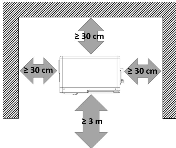
Verificar que la salida del aire no tenga con obstáculos que causen que el aire saliente entre de nuevo a la máquina. Conservar espacio suficiente para acceder al control de la temperatura.
