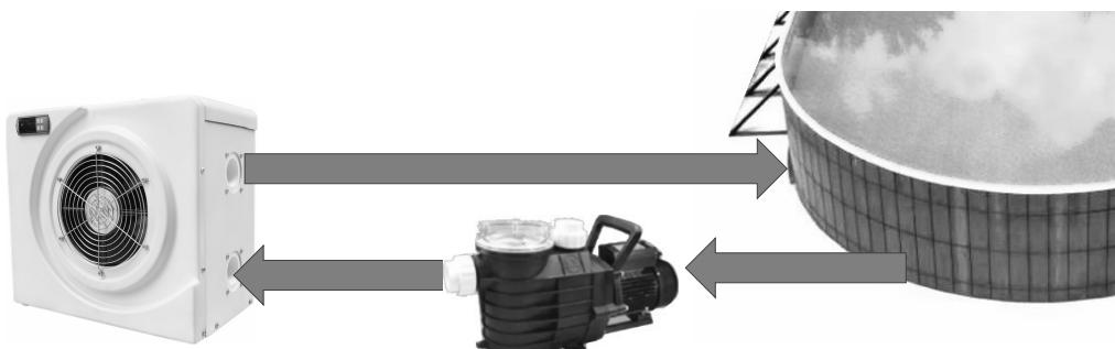
Si su instalación contiene un equipo de tratamiento de aguas (cloro, bromo, cloración salina, etc.), esta máquina tiene que estar instalada antes del equipo de tratamiento de aguas con una válvula de antirretorno entre bomba de calor y tratamiento de aguas.
