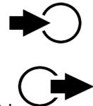
La sortie d'eau réchauffée se raccorde à la connexion haute indiquée par le symbole :
