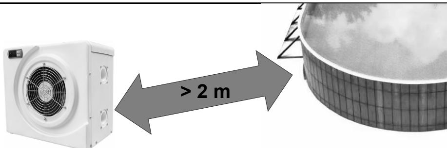
Instale la bomba de calor de la piscina en una superficie plana, horizontal y estable. (La base de concreto sería ideal). Mantener 1m (40") / mínimo 30cm (12") de espacio libre delante de las rejillas verticales de aspiración de aire y mínimo 3m (120") a la salida del ventilador en un espacio libre.
