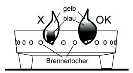
Sollte einer dieser Punkte nicht zutreffen, liegt eine Störung der/s Brenner(s) vor. Eine umgehende Reinigung der Brenner (und Ventile) ist erforderlich, um wieder einen sicheren Betrieb zu ermöglichen.
