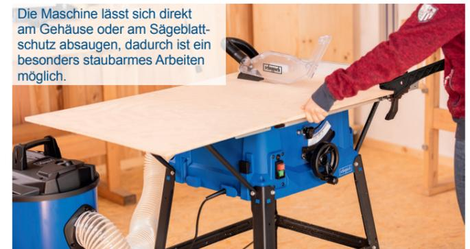
Die Maschine lässt sich direkt am Gehäuse oder am Sägeblattschutz absaugen, dadurch ist ein besonders staubarmes Arbeiten möglich.
