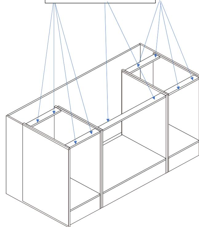
Bitte vor dem Ausschneiden die eckpunkte von dem Obere laminierte seite an dem Eckpunkten durchbohren!
