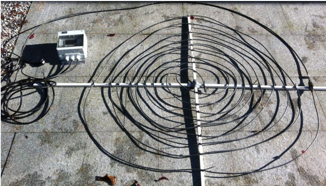
Hilfsrahmen aus dünnen Kabelkanälen mittels Kabelbindern fixiert
