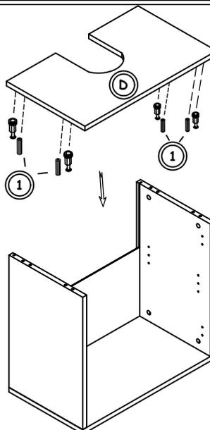
OBERES BRETT PLATZIEREN UND DURCH SCHRAUBEN DER MINIFIX-ELEMENTE BEFESTIGEN.
