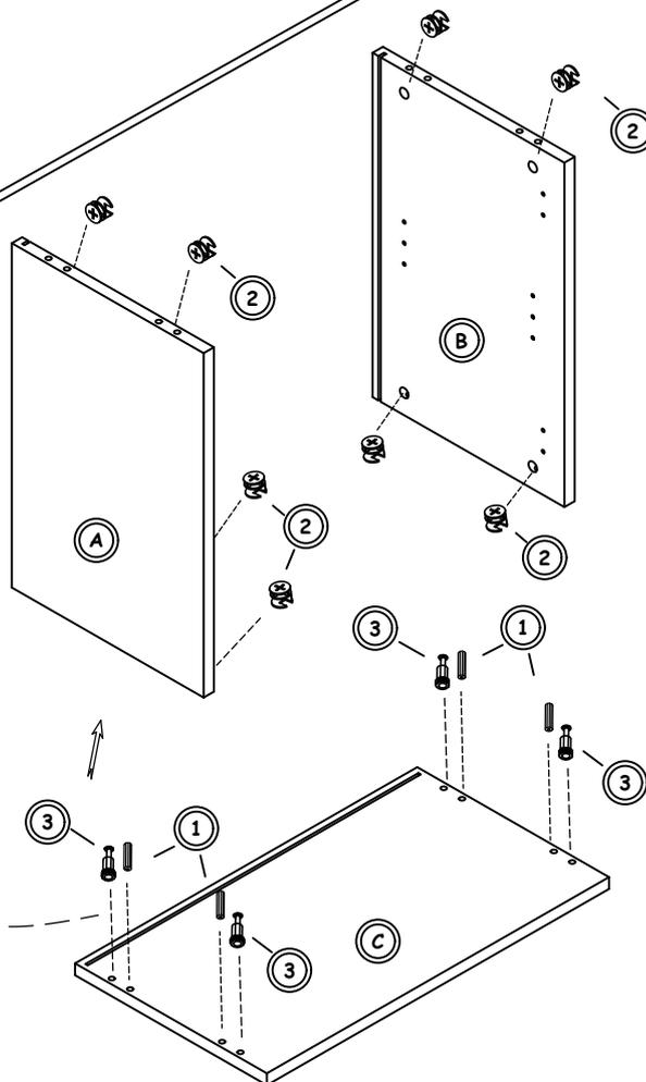
PLATZIEREN SIE DIE MINIFIX STECKER UND VERBINDERGEHÄUSE UND SCHRAUBEFESN SIE DIESE FEST.
