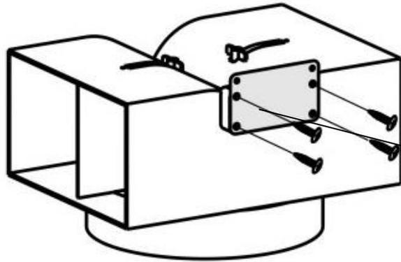
Befestigen Sie die mitgelieferte Halteplatte mit 4 Stck. ST3\*12mm Schrauben an der Umluftweiche
