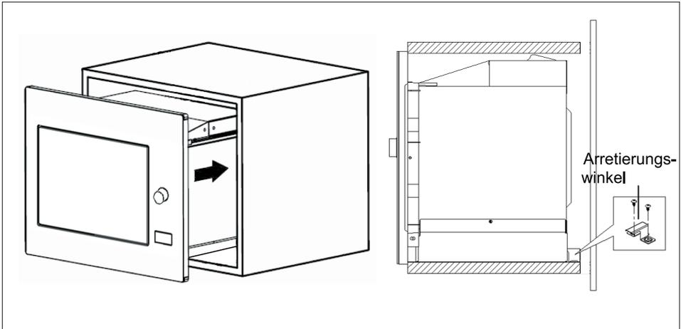
5. Öffnen Sie die Tür und befestigen Sie den Ofen mit Schraube B an der Einbaubohrung am Schrank. Bringen Sie dann die Kunststoffabdeckung auf der Einbaubohrung an.
