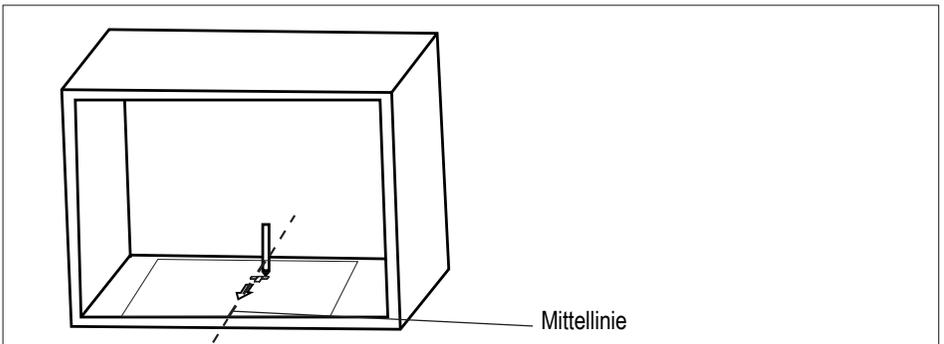
3. Nehmen Sie die Schrankbodenschablone heraus und befestigen Sie den Arretierwinkler mit den 2 Schrauben A.
