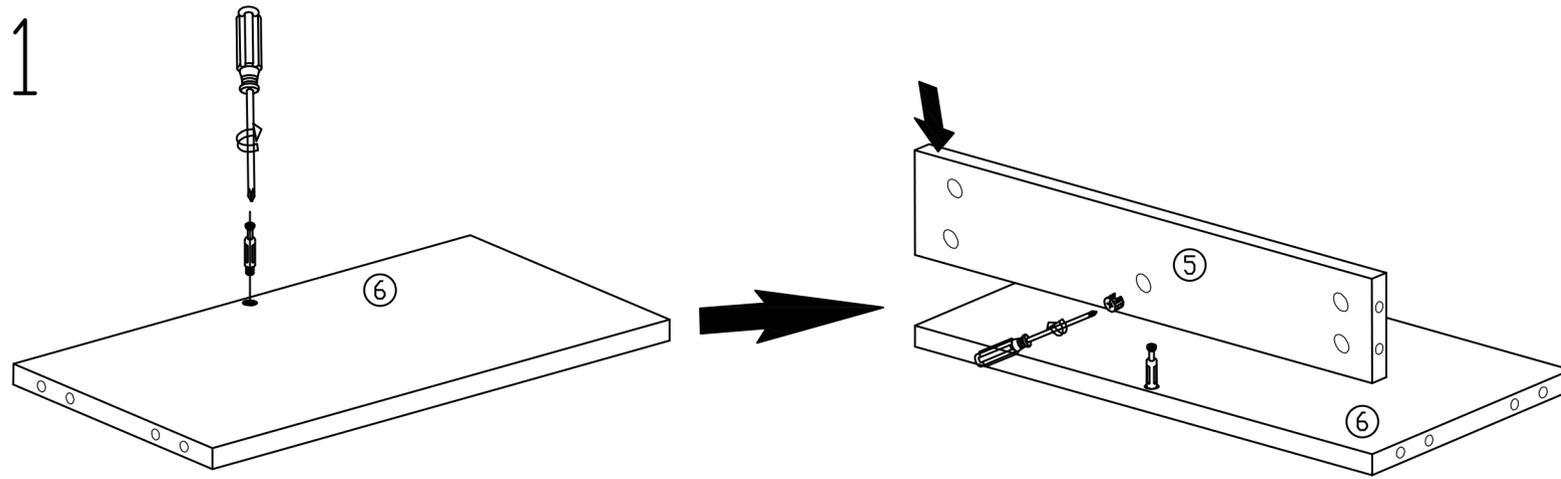
Stecken Sie die Schraube in das vorhergesehene Loch von Brett Nr. 6 und ziehen Sie sie fest. Legen Sie Brett Nr. 5 mit dem Loch auf die Schraube, dann ziehen Sie die Schraube mit der exzentrischen Radmutter im Uhrzeigersinn fest.
