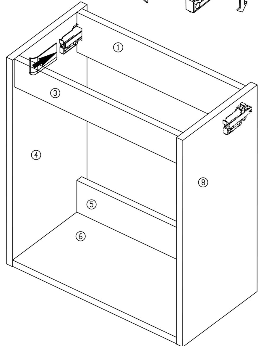
Richten Sie den Schrankaufhänger auf den Seitenbrettern Nr. 4 und 8 aus und schrauben Sie ihn mit dem Kreuzschlitzschraubendreher fest. Sie können den Schrankaufhänger auch mit Hilfe der kleinen Schrauben feinjustieren. (siehe Abb.)
