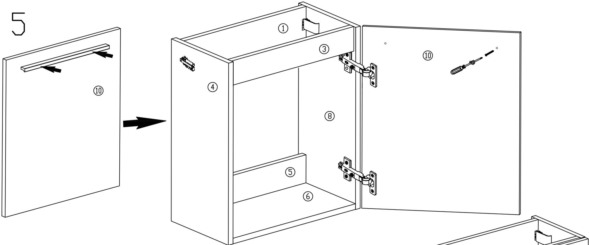
Stellen Sie Griff Nr.11 auf die Schranktür Nr.10 und schrauben Sie ihn fest. Kleben Sie die Schrauben-Abdeckung auf die exzenter Radmuttern.
