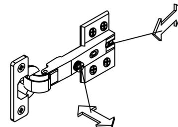
Setzen Sie das Scharnier auf die Schranktür Nr. 10 und schrauben Sie es fest. Dann schrauben Sie die andere Seite des Scharniers auf das Seitenbrett Nr. 8 und stellen das Scharnier so ein, dass Tür- und Seitenbrett bündig sind. (siehe Abb.)
