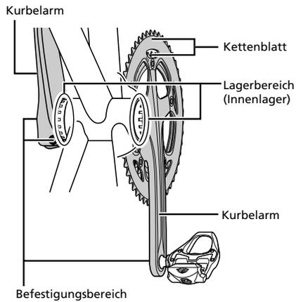
Modelle mit einer Achse am linken Kurbelarm
