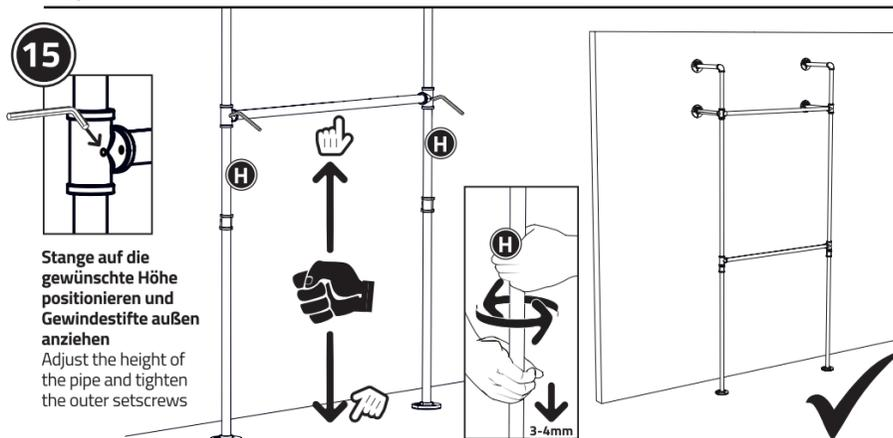
**Stange auf die gewünschte Höhe positionieren und Gewindestifte außen anziehen**
