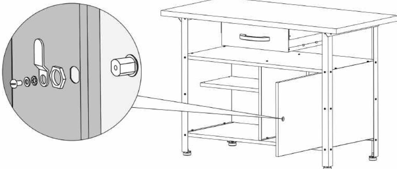
Stecken Sie den Schließzylinder des Schlosses (L) durch die in der Tür vorgesehene Öffnung und fixieren Sie ihn wie in der Abbildung. Prüfen Sie vorher, ob die Schließrichtung korrekt ist.
