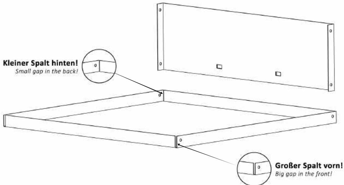
Setzen Sie die Schubladenrückwand (S6) auf den Schubladenboden (S3). Schrauben Sie die beiden Teile noch nicht zusammen!
