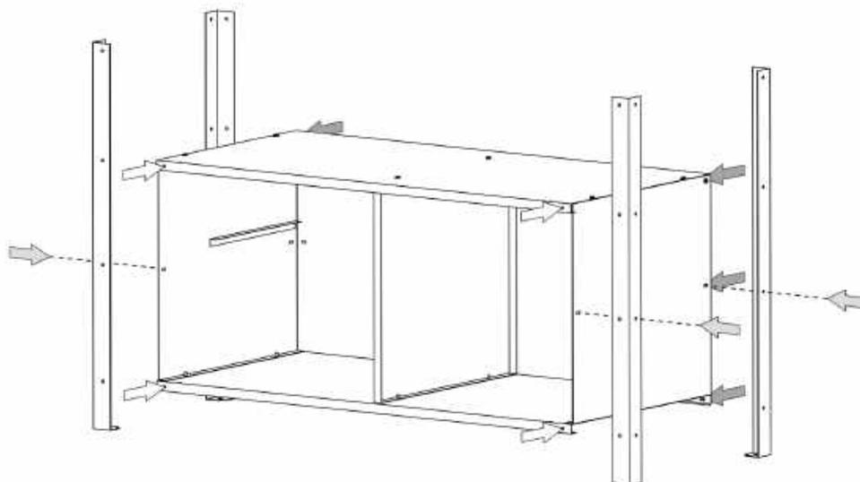
Schrauben Sie die 4 Tischbeine (K1) an die Konstruktion.
