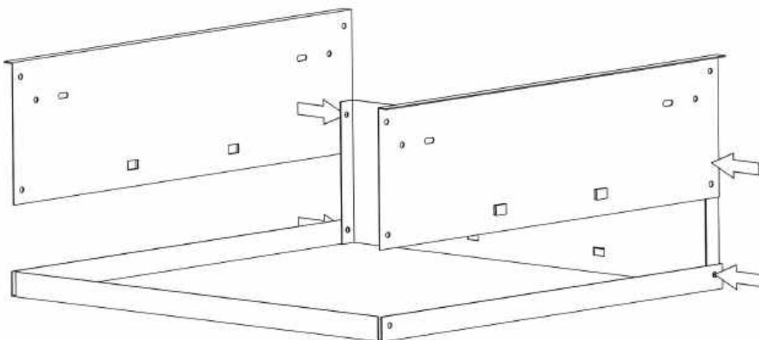
Schrauben Sie jetzt beide Schubladenseitenwände (S5), die Schubladenrückwand sowie den Schubladenboden zusammen. Achten Sie beim Verschrauben der Einzelteile darauf, dass die Schraubenköpfe außen sitzen und die Muttern sowie Unterlegscheiben innen sitzen.
