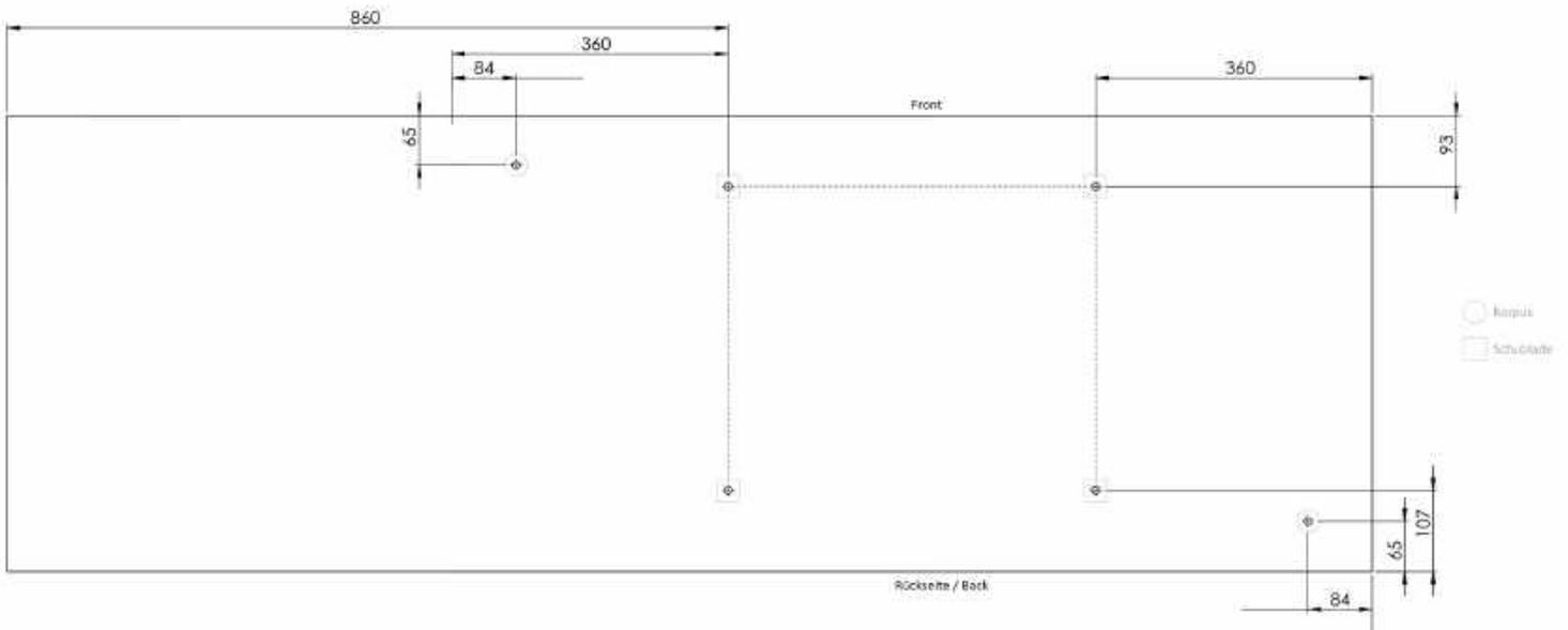
Markieren Sie die benötigten Befestigungspunkte auf der Unterseite der Arbeitsplatte (10).
