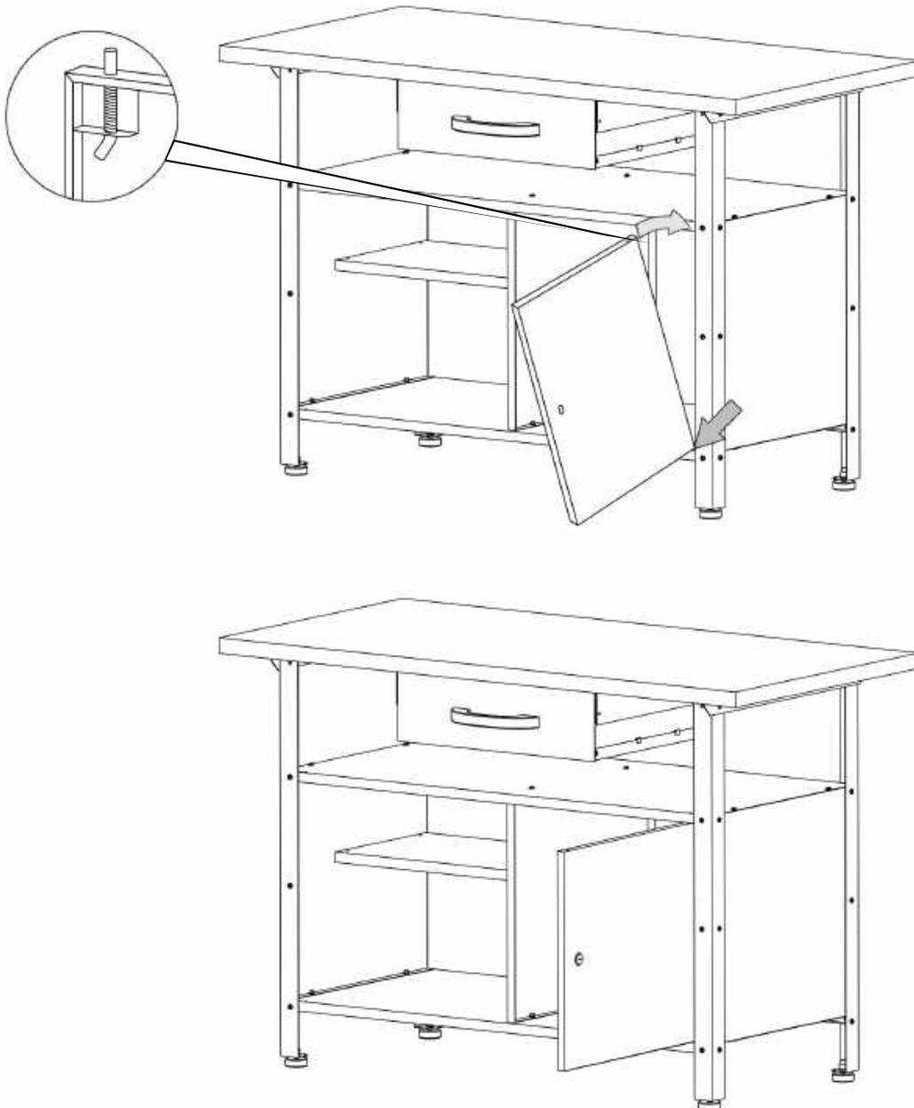
Bringen Sie die Tür in Position zu den Türsplint-Löchern im Werkbank-Korpus und stecken oben und unten je einen Federsplint (D4) in die vorgesehenen Türlöcher mit der Feder in der Türsplint-Vorrichtung (siehe Detail-Abbildung).
