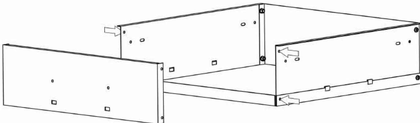
Schrauben Sie die Schubladenfront (S2) an die Schubladenseitenwände.
