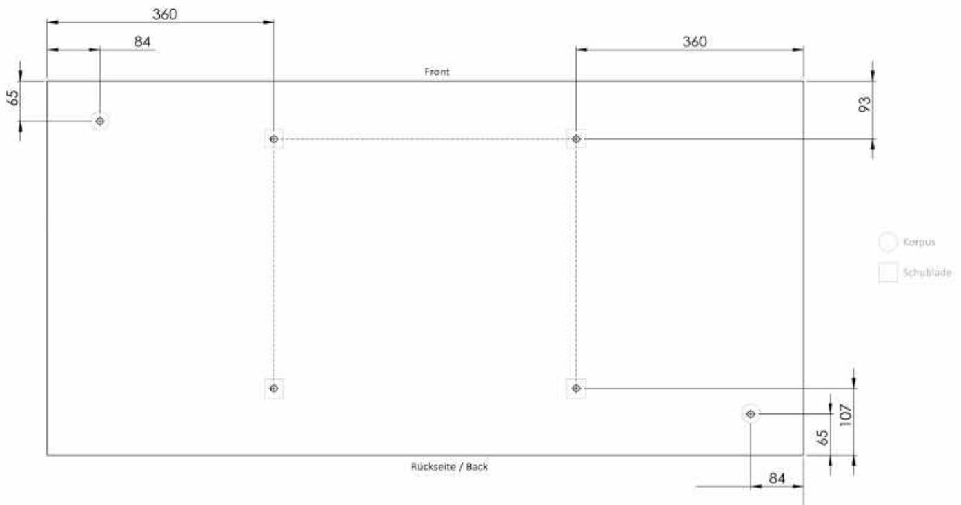
Markieren Sie die benötigten Befestigungspunkte auf der Unterseite der Arbeitsplatte (AP).
