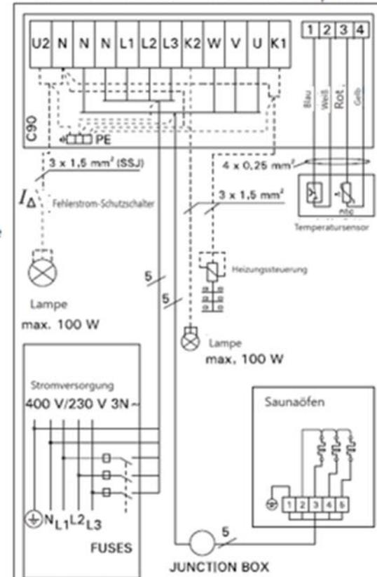
Abb. 12b: Externe Steuerung CH90 mit BC-E-Serie Anschlussplan für das 3-Phasen-Netz des Saunaofens
