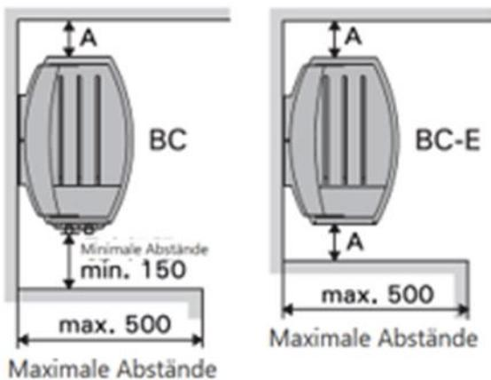
Der Ofen kann in eine Wandnische mit einer Mindestwandhöhe von 1,9 m eingebaut werden.
