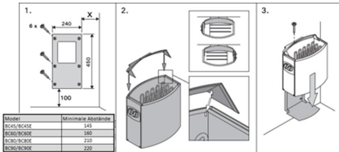
Abbildung 7: Montage eines Saunaofens an der Wand
