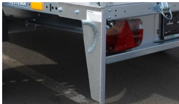
Stützeinrichtung Kastenanhänger (nicht an allen Kastenanhängern)
