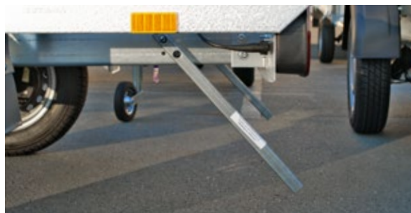
Stützeinrichtung Motorradtransporter - MT750
