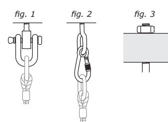
dans le bois et être bloqué par le haut avec un écrou, voir fig. 3. Montez la balançoire uniquement comme cela est décrit dans ce mode d'emploi. Toute autre méthode de fixation pourrait endommager le câble ou l'élément de support.
