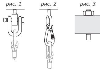
верхней стороне зафиксировать контргайкой, чтобы обеспечить достаточное безопасное соединение, см. рис. 3.
