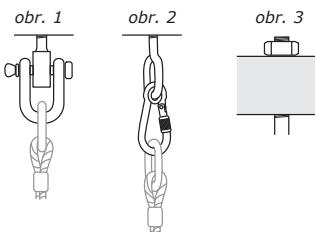
teckt sein und von oben mit einer Mutter gesichert werden, um eine ausreichend sichere Verbindung zu erreichen, siehe Abb. 3.
