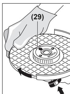
Tekan tombol penahan spindel (1) untuk menahan spindel gerinda. Untuk mengencangkan mur penjepitan cepat, putar mata gerinda searah jarum jam dengan kuat.
