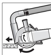
Ligue a ferramenta elétrica e coloque-a sobre a peça com a parte dianteira do patim de guia. Desloque a ferramenta elétrica com um avanço uniforme e adequado ao material a processar.
