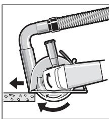
Mettez en marche l'outil électroportatif et posez-le sur la pièce avec la partie avant de la glissière de guidage. Déplacez l'outil électroportatif sur la pièce avec une vitesse d'avance modérée, adaptée au type de matériau.
