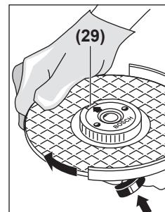
مهره مهار سریع طبق مقررات تعیین شده و بدون عیب را می‌توان با هرخاندن رینگ کنگره دار در خلاف جهت عقربه های ساعت با دست باز کرد. مهره مهار سریع سفت شده را هرگز توسط یک آچار شلاقی باز نکنید، بلکه از یک آچار دو سوزنه استفاده نمایید. آچار قرار دهید. آچار دوسوزن را مانند تصویر
