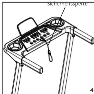
**Schritt3.** Schalten Sie den roten Sicherheitsschalter ein, da sonst ein E7-Fehler auftreten kann;
