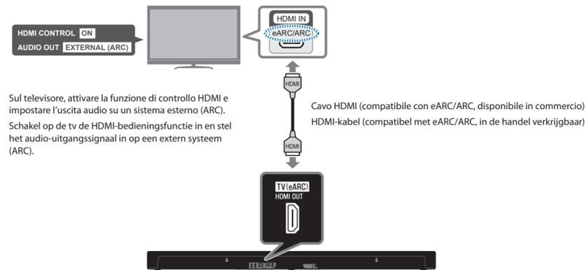
Sul televisore, attivare la funzione di controllo HDMI e impostare l'uscita audio su un sistema esterno (ARC).
