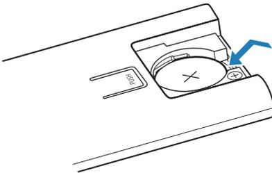
**3** Setzen Sie eine neue Batterie ein und schieben Sie die Abdeckung wieder in Pfeilrichtung fest an seinen Platz.
