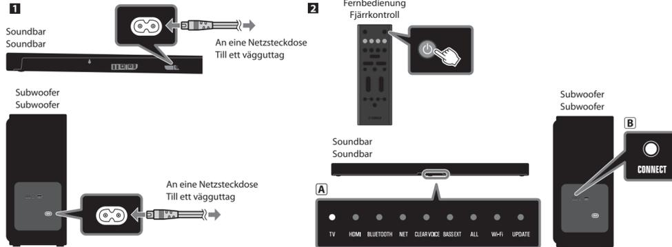
1 Anslut soundbaren och subwoofer till ström med medföljande nätsladdar. Efter att ha anslutit strömmen, vänta en stund till dess att indikatorerna på soundbarens framsida blinkar i ungefär en minut. Kontrollera att indikatorerna på soundbarens framsida är avslagna och att CONNECT-indikatorn på baksidan av subwoofern blinkar och gå sedan till nästa steg.
