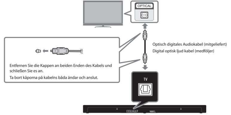
Entfernen Sie die Kapfen an beiden Enden des Kabels und schließen Sie es an.
