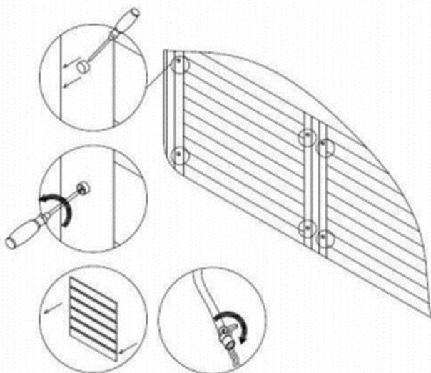
Ziehen Sie das Anschlusskabel durch die Öffnung der Seitenverkleidung und verschrauben Sie die Klappe wieder (Das Anschlusskabel ist nicht im Lieferumfang enthalten).
