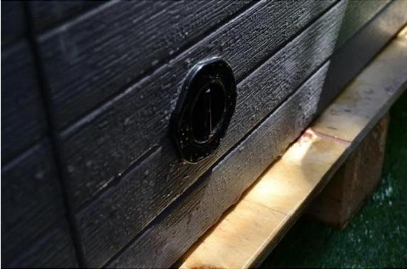
Ziehen sie die Schraubvorrichtung ein Stück heraus. Danach drehen Sie die Vorrichtung und dann können Sie den Abfluss weiter herausziehen. In dieser Position entweicht noch kein Wasser. Danach schrauben sie die Abdeckkappe ab.
