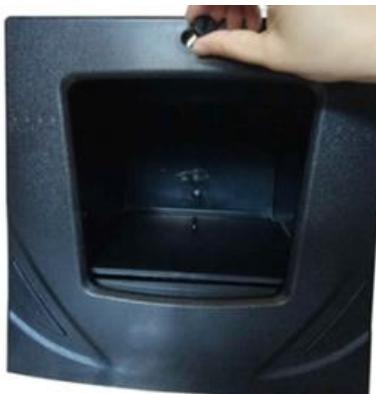
Im weiteren Verlauf schieben Sie die Abdeckung nach oben und nehmen das Gitter heraus.
