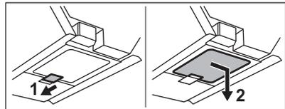
2. Schieben Sie die Tropfschale vertikal nach unten. Achten Sie darauf, dass kein Wasser verschüttet wird.
