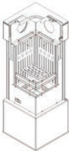
21. Kolejność demontażu oraz wymiany deflektora i wyłożenia accumote – THOR The procedure for the baffle and Accumotte lining disassembly and replacement – THOR
