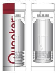
Denn dieses Reservoir hat Platz für Expansionswasser, weil die Kesselwand aus Edelstahl flexibel ist. Ein Teil des Reservoirs ist als Balg konzeptioniert, der sich bei jedem Aufheizen des Wassers etwas ausdehnen kann. Sobald Wasser abgezapft wird, schrumpft der Balg in seine Ausgangsposition zurück und ist wieder bereit, frisches Leitungswasser aufzuheizen.
