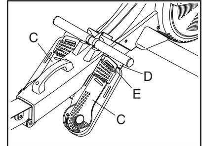
**Stellen Sie die andere Fußunterlage (C) auf die gleiche Weise ein. Achten Sie darauf, dass beide Fußunterlagen in der gleichen Position sind.**
