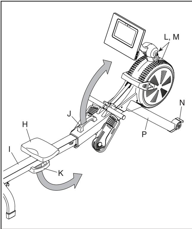
Als Nächstes halten und heben Sie den Rahmengriff (J) und den Schienengriff (K) und kippen das Rudergerät nach vorn auf die Schutzkappe (L, M) und die Lagerungsfüße (N) (siehe Abbildung rechts).
