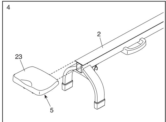
5. Schieben Sie den Sitz (23) bis zum Vorderteil der Schiene (2).
