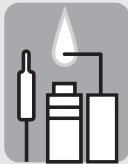
Abb. 4a: Wächterflamme brennt falsch
