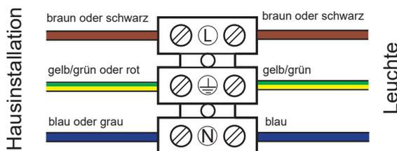
10. Schließen Sie die Anschlusshülsen der Lüsterklemme, indem Sie die zuvor gelösten Schrauben wieder anziehen. Achten Sie dabei auf den richtigen Sitz der Kabellitzen.
