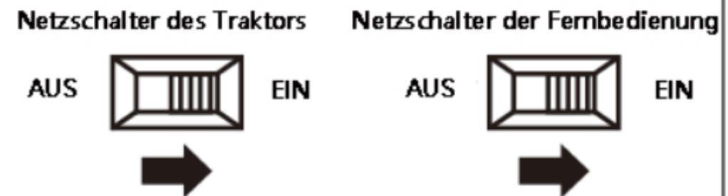
Zu diesem Zeitpunkt findet die Fernbedienung automatisch die Frequenz, die Lampe blinkt, wenn die Lampe der Fernbedienung aufhört zu blinken. Die Frequenzanpassung ist abgeschlossen, die Fernbedienungsfunktion kann normal verwendet werden.
