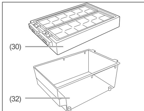
3. Nehmen Sie den Eiswürfelbereiter (30) vom Vorratsbehälter (32) ab, und entnehmen Sie die Eiswürfel. Benutzen Sie dazu am besten eine Eisschaufel (nicht im Lieferumfang enthalten), um Kälteverletzungen zu vermeiden.
