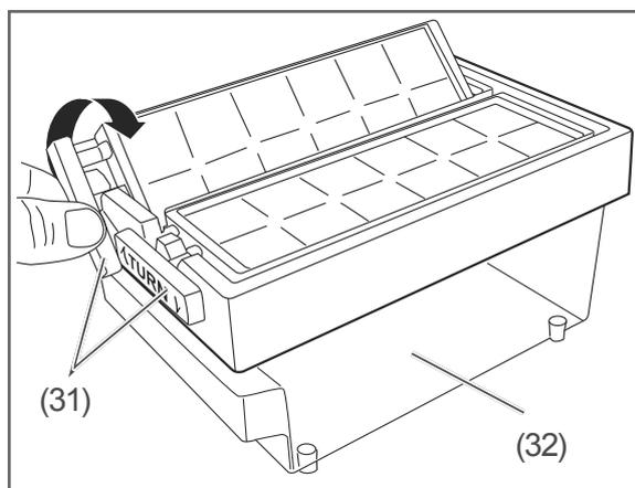
2. Zum Entnehmen von Eiswürfeln drehen Sie die Hebel (31) im Uhrzeigersinn. Die Eiswürfel fallen in den Vorratsbehälter (32).
