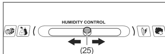
Die Glasablage (5) im Kühlbereich verfügt über einen Schieberegler (25) zur Feuchtigkeitskontrolle.
