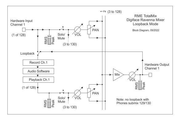
Das Blockschaltbild zeigt, wie das Eingangssignal der Software über Playback ausgegeben, und von dort über den Hardware-Output zurück zum Softwareeingang gelangt.
