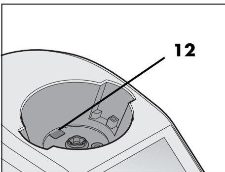
In der Aufnahme für den Mixbehälter **10** befindet sich ein Überlauf **12**.
