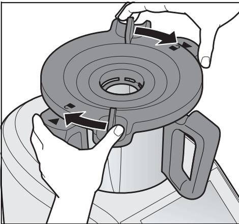
1. Setze den Deckel **23** für den Mixbehälter so auf, dass die Schlosssymbole gegenüber den Pfeilen auf dem Mixbehälter **5** sind.
