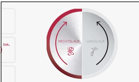
1. Drücke auf **DREHRICHTUNG**. Rechts im Bildschirm werden die beiden Drehrichtungen angezeigt.
