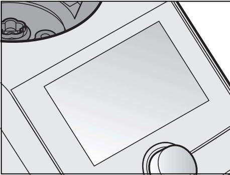
Wenn keine Funktion aktiv ist und ca. 5 Minuten keine Bedienung erfolgt, erscheint im Bildschirm **7** ein Dialogfeld, in dem die Zeit bis zum Umschalten in Standby herunter gezählt wird.
