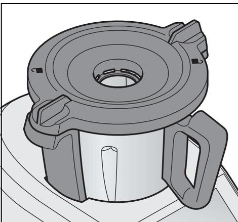
Erst wenn der Deckel **23** richtig verschlossen ist, kann das Gerät starten. Wenn du dich in einem Programm befindest, zeigt ein Tonsignal an, dass das Gerät betriebsbereit ist.
