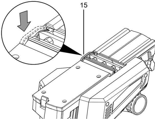
3. Schieben Sie das Spannelement (16) seitlich aus der Messerwelle (14).
