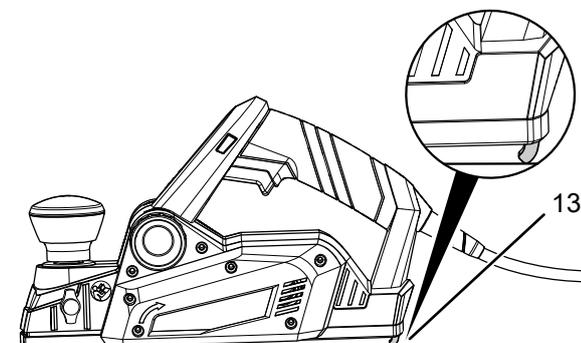
2. Wenn Sie weiterarbeiten möchten, setzen Sie das Gerät zunächst mit der vorderen Hobelsohle auf und bringen Sie während des Vorschubs die hintere Hobelsohle wieder in Kontakt mit dem Werkstück. Der Parkschuh (13) klappt dabei wieder hoch.
