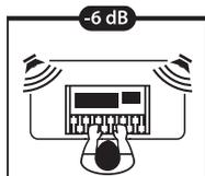
Wenn die Monitore in der Nähe einer Raumecke aufgestellt werden, stellen Sie den Schalter Acoustic Space zunächst auf -6 dB, was für eine maximale Bassdämpfung sorgt.
